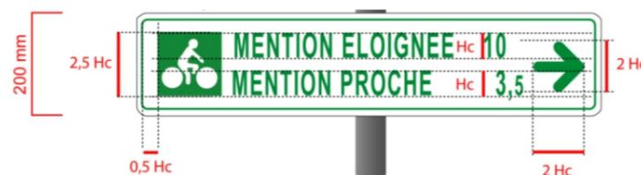
Réglementation : La hauteur normale de composition **Hc** est de 40 mm. Cette hauteur peut-être portée à 50 mm en présignalisation. Elle peut être réduite exceptionnellement à 30 mm en position (problème d'encombrement, sortie d'aire d'arrêt, etc.).
